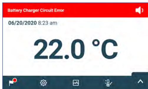
Schermata iniziale con allarme attivo
