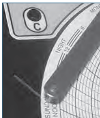
Stylet et rainure de la ligne temporelle de l'enregistreur graphique
