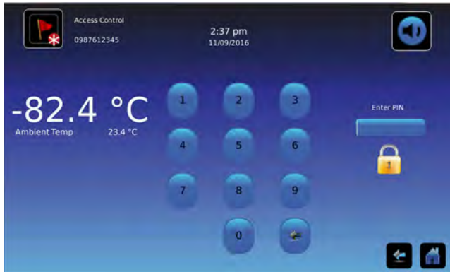
Teclado de Control de acceso
