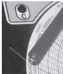
Lápiz del registro gráfico y ranura de la escala de tiempo
