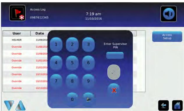
Tela Access Control Setup (Configuração do Controle de Acesso) com sobreposição de teclado de senha
