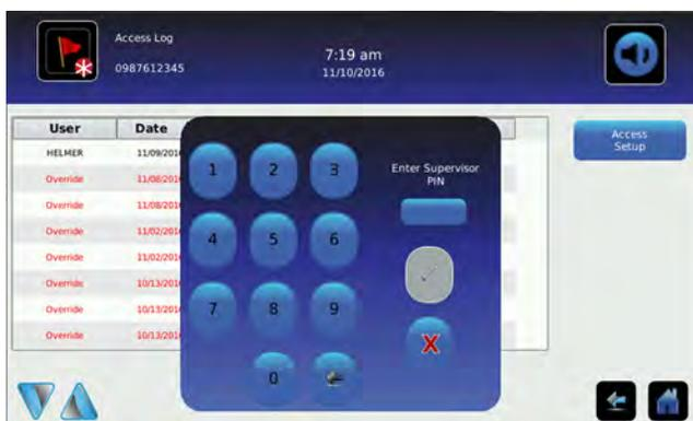
Einrichtungsbildschirm für die Zugangskontrolle mit überlagertem Kennwortastatur
