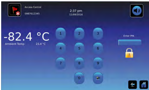
Clavier du contrôle d'accès
