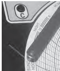
Styilet et rainure de la ligne temporelle de l'enregistreur graphique
