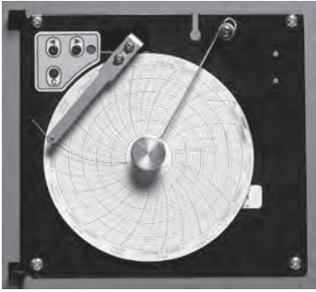
Enregistreur graphique avec papier millimétré installé
