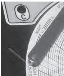
Nadel des Aufzeichnungsgeräts und Zeitleistennut
