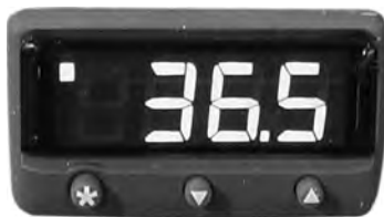
Pantalla del controlador de temperatura.
