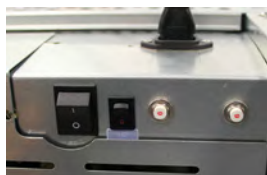
Figur 4: Strömbrytaren PÅ/AV (vänster), övervakningssystemets/åtkomstkontrollens PÅ/AV-brytare för reservbatteriet (mitten), automatsäkring (endast system med 230 V) (höger).
