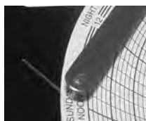
Figur 3: Kurvskrivarens nål och tidslinjens spår.
