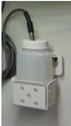
Figur 1: Övre sond, sondflaska och flaskhållare.
