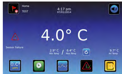
Figura 14: Pantalla de inicio con alarma activa.
