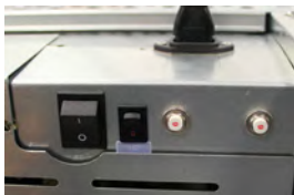
Figura 4: Interruptor ON/OFF de CA (izquierda), interruptor de ON/OFF de la batería de reserva del control de acceso/sistema de monitoreo (centro), disyuntores (solo sistemas de 230 V) (derecha).
