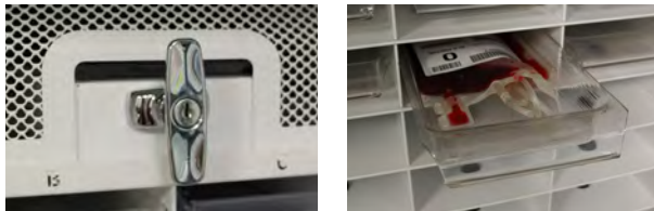
Figura 20 (sinistra): Maniglia di sblocco e di blocco di bypass (mostrata in posizione di sblocco). Figura 21 (destra): Vassoio individuale (indicato con il sacchetto di sangue conservato nel vassoio).
