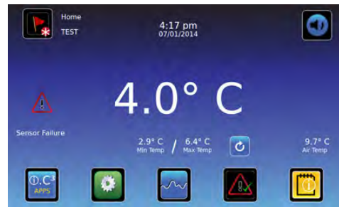
Figura 14: Schermata Home con allarme attivo.
