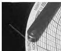
Figura 3: Grafico registratore puntina e linea di scanalatura del tempo.
