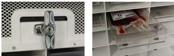
Figure 20 (à gauche) : poignée de débrayage et serrure (position déverrouillage sur la photo)
