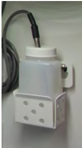
Figure 1 : sonde supérieure, flacon de sonde et support de flacon
