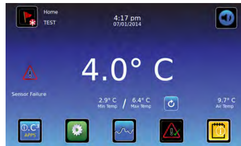
Figure 14 : écran d'accueil avec alarme active
