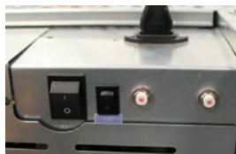
Figur 4: Vekselstrøms TIL/FRA afbryder (venstre), overvågningssystemets/adgangskontrollens backup-batteris TIL/FRA afbryder (midten), hovedafbrydere (kun 230 V systemer) (højre).
