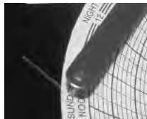
Figura 3: Puntina del registratore grafico e scanalatura temporale.
