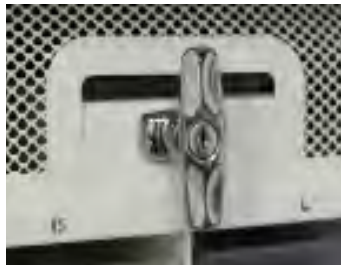
Figura 20 (sinistra): Maniglia di sblocco e di blocco di bypass (mostrata in posizione di sblocco).
