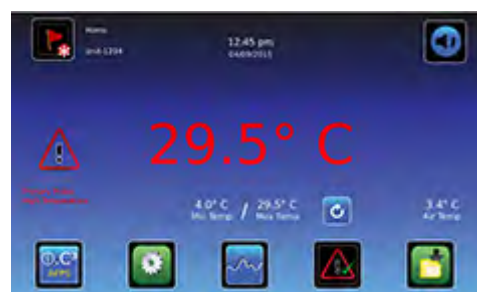
Figura 14: Schermata Home con allarme attivo.
