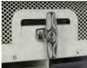
Figure 20 (à gauche) : poignée de débrayage et serrure (en position déverrouillée sur la photo).
