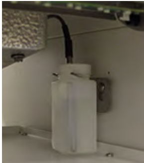
Figure 1 : sonde principale, flacon de sonde et support du flacon.
