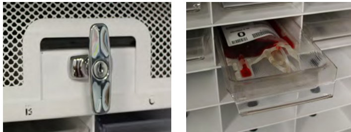
Figur 20 (venstre): Bypass-frigørelseshåndtag og lås (vist i åben position).
