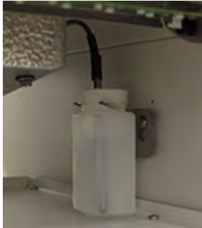
Figur 1: Primær probe, probeflaske og flaskeholder.
