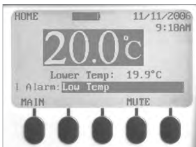
Главный экран с одной подсвеченной активной сигнализацией (низкая температура).
