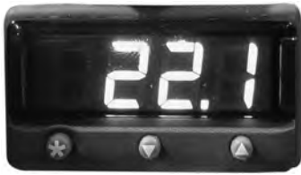
Visor e botões do controlador/monitor de temperatura.
