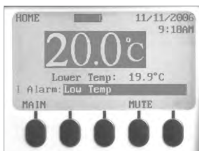
Ecrã Home com um alarme ativo (Low Temp), realçado.
