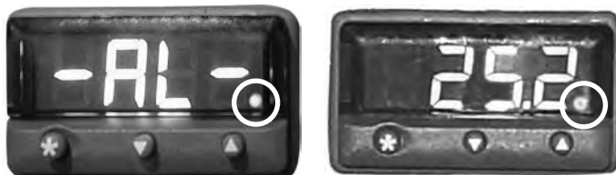
Controlador/monitor de temperatura em condição de alarme (luz vermelha assinalada com círculo).
