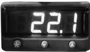
Visor e botões do controlador/monitor de temperatura.
