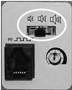
Controlo do volume do alarme (assinalado com círculo).
