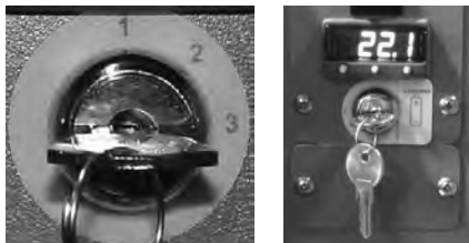
Lado esquerdo: Interruptor de chave de alarme (PC4200h). Lado direito: Interruptor de chave de alarme (todos os outros modelos da Horizon Series).
