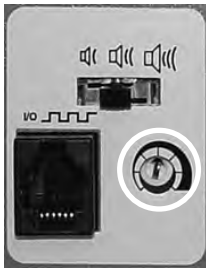
Controlo do atraso do alarme (assinalado com círculo).
