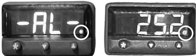
Monitor/centralina della temperatura in condizione di allarme (spia rossa cerchiata).
