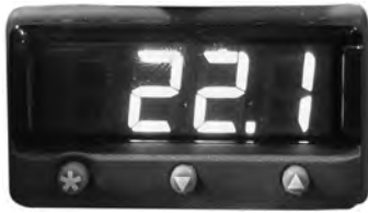
温度监控器/控制器显示和按钮。
