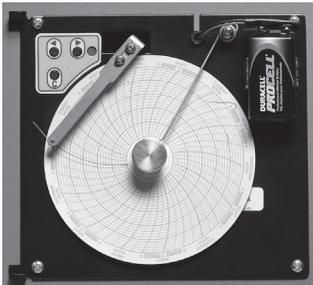
El registrador gráfico tiene un sistema de batería de reserva que permite un período de funcionamiento continuo en caso de fallo de energía. La duración de la batería varía según el fabricante y el nivel de carga restante. Si la batería está completamente cargada, la energía de reserva para el registrador gráfico de temperatura durará hasta 14 horas.
