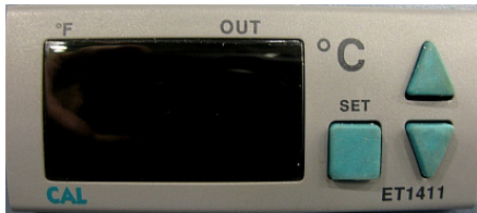
Monitor e controlador de temperatura.
